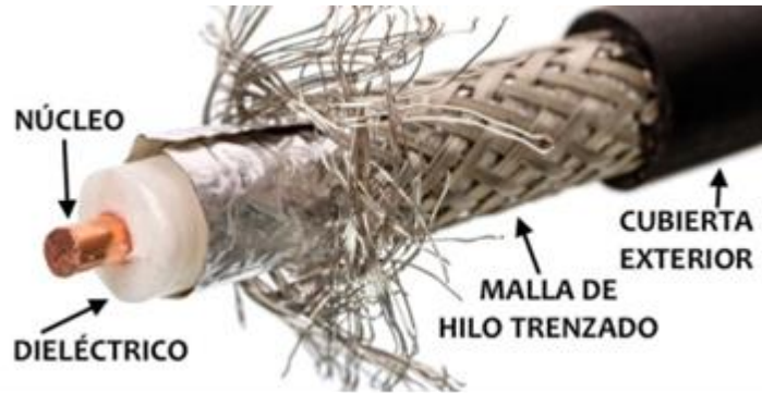
Figura III. Cable coaxial usado como línea de transmisión [10].
