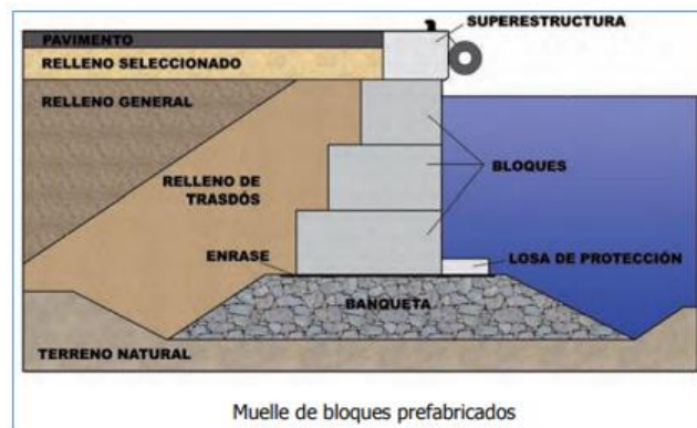
Figura 1. Estructura de muelle de bloques prefabricados
