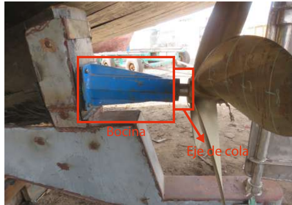
FIGURA N° 2.29: Bocina y eje de cola de un barco. Fuente propia.
