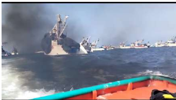
FIGURA N° 1.2: Presencia de humo negro por sobrecarga de motor en una panga. Fuente propia.
