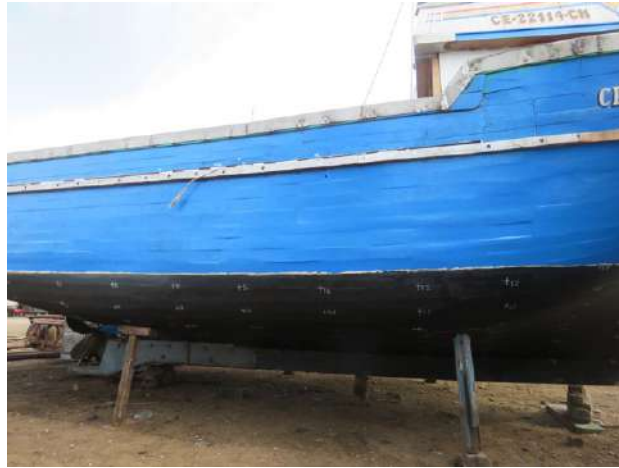
FIGURA N° 3.3: Ubicación de puntos en la obra viva del casco DELIA I . Fuente propia.
