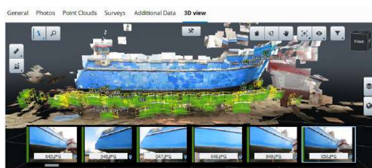
FIGURA N° 4.7: Aerotriangulación del modelo-ContextCapture. Fuente propia.
