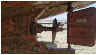
(a) Mal aprovechamiento de espacios para hélice, es una hélice muy inferior en tamaño a la que requiere el barco. Fuente propia.
