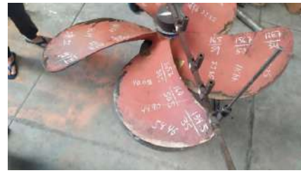
(b) Hélice marina de 56 pulgadas de diámetro con paso incorrecto y mal distribuido. Fuente propia
