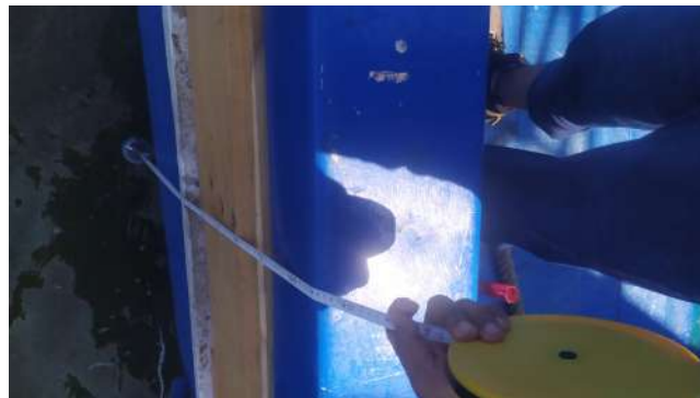
FIGURA N° 4.20: Medición de francobordo barco DELIA I. Fuente propia.
