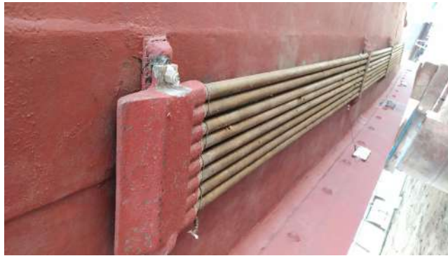
FIGURA N° 2.31: Keel cooler de un barco. Fuente propia.
