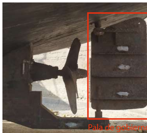
FIGURA N° 2.30: Pala de gobierno de un barco. Fuente propia.
