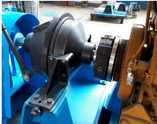
Figura 3.7: Motor marino acoplado mediante un acoplamiento flexible a embrague mecánico
