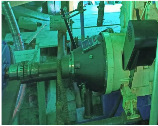
Figura 3.6: Motor marino acoplado directamente a embrague mecánico.
