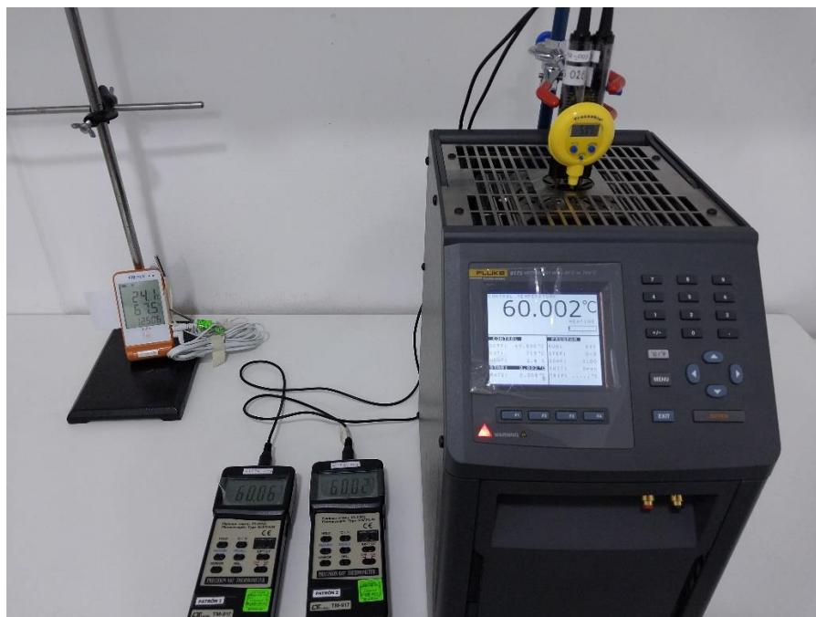
Anexo 86: Realización de calibración en el laboratorio de temperatura y fisicoquímica.
