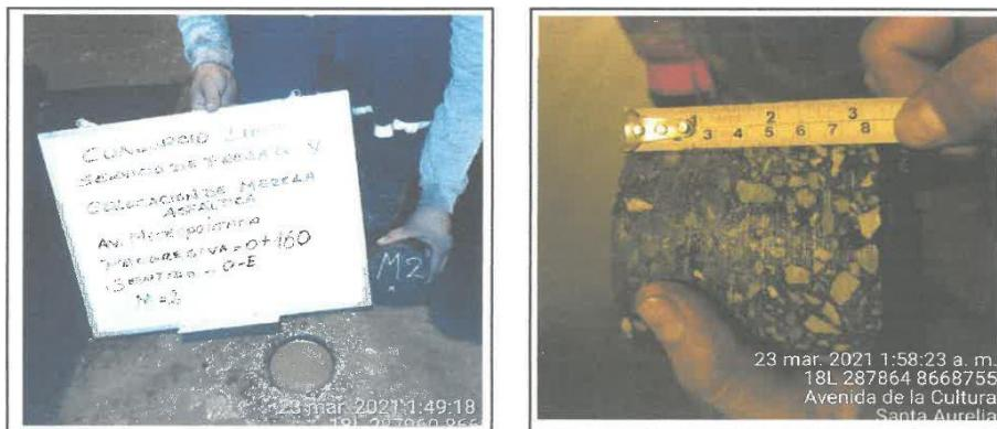
En total se realizaron 28 diamantinas en la Av. Metropolitana, con el objetivo de efectuar la medición de los espesores de los testigos diamantinos, a fin de revisar el cumplimiento de la normativa referida, tal como se muestra en la siguiente tabla.
