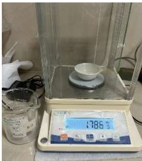
Figura 36. Pesaje del carbonato de litio obtenido empleando \text{Na}_2\text{CO}_3
