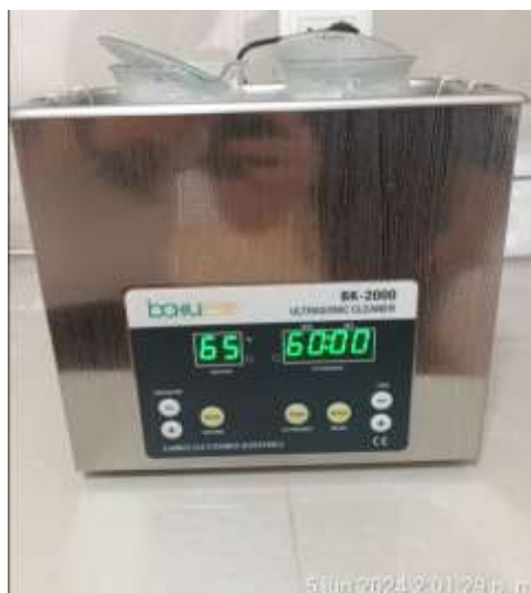
Figura 31. Proceso de lixiviación de baño de ultrasonido lixiviando a 60°C por 60 min
