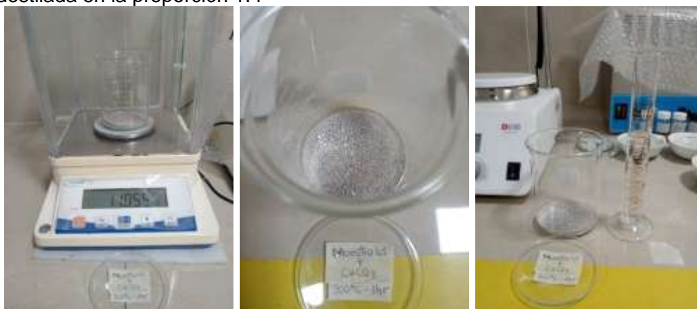
Figura 20. Pesaje de las muestras calcinadas y luego se le adicionó agua destilada en la proporción 1:4
