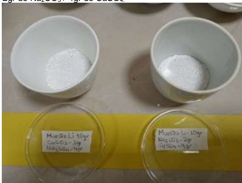
Figura 16. Se preparó 2 crisoles con 10gr de tobas volcánicas de litio, a las cuales se le adicionó: 2gr de \text{CaCO}_3 + 4gr de \text{Na}_2\text{SO}_4 y 2gr de \text{Na}_2\text{CO}_3 + 4gr de \text{CaSO}_4 .
