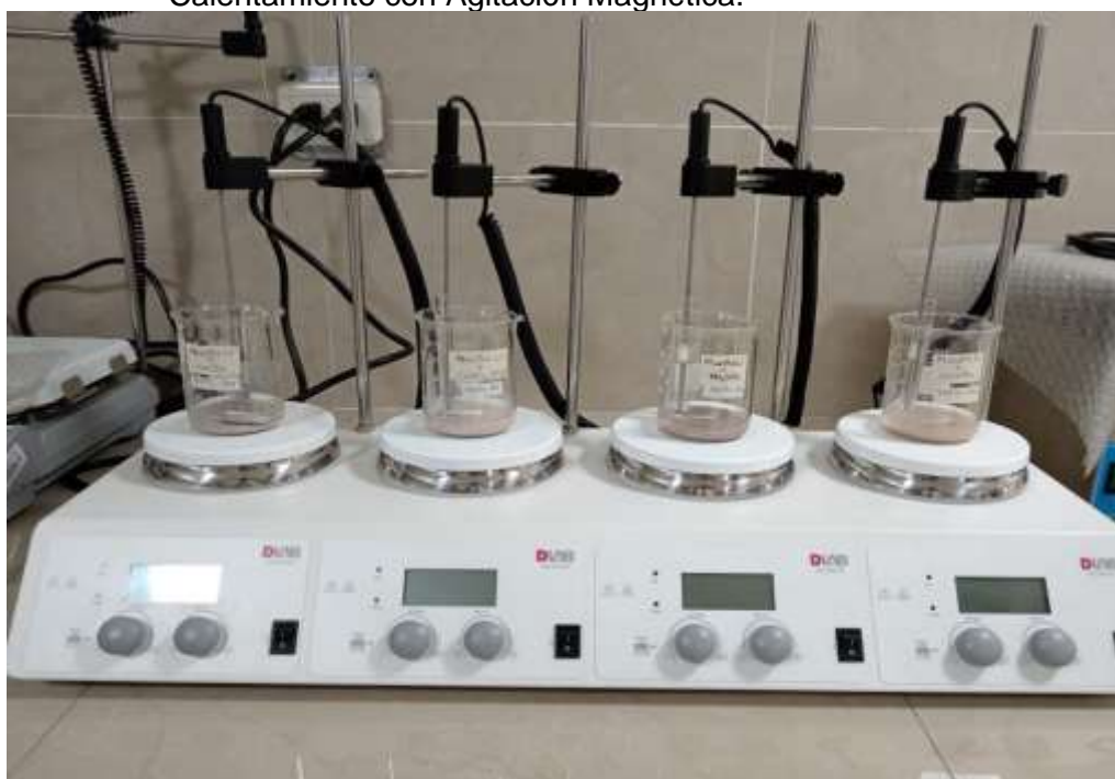
Figura 21. Vasos de precipitados conteniendo las muestras tostadas a 900°C por 1hr y lixiviadas con agua destilada colocadas en Plancha de Calentamiento con Agitación Magnética.
