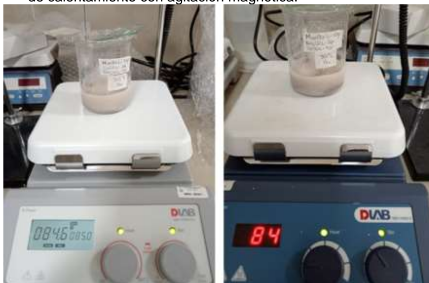
Figura 26. Proceso de lixiviación fue realizado a 85°C por 60 minutos en planchas de calentamiento con agitación magnética.
