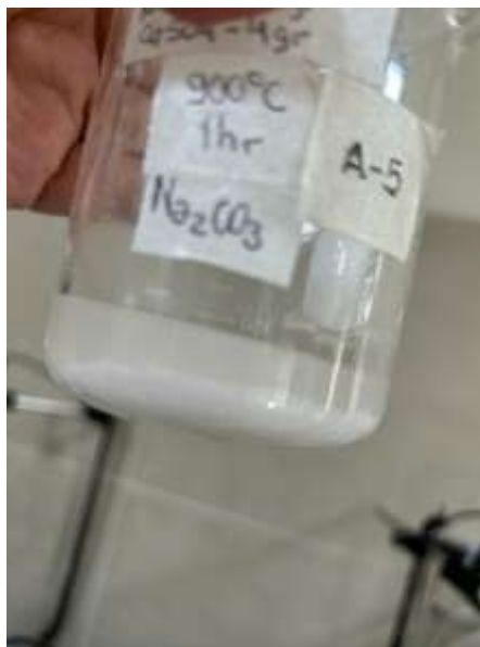
Figura 34. Formación de precipitado al finalizar el proceso de lixiviación con agitación y temperatura.
