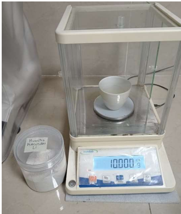
Figura 14. Pesaje de la muestra original de litio en 10gr.
