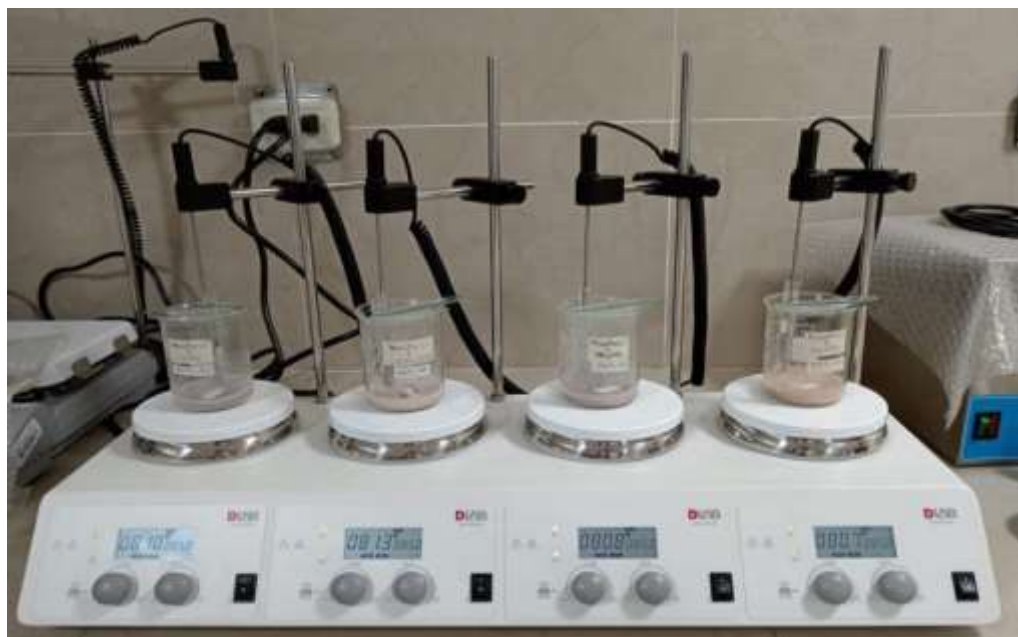
Figura 22. Proceso de lixiviación fue realizado a 85°C por 60 minutos
