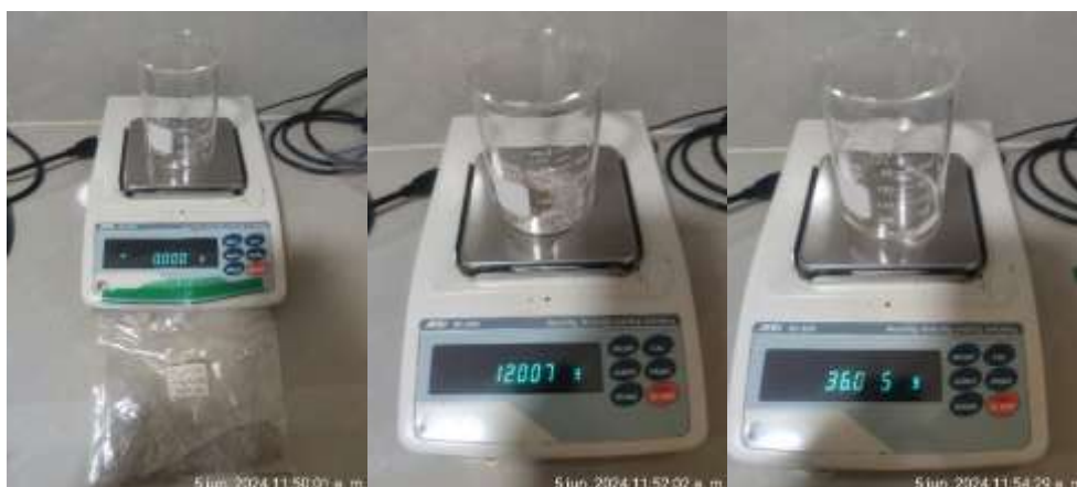
Figura 28. Pesaje de 12 gr de muestra N°7 y 36 gr de agua destilada para la lixiviación
