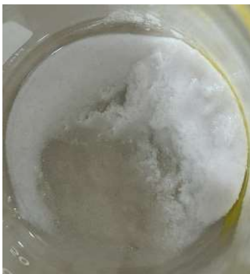
Figura 35. Filtración del precipitado obtenido al formar carbonato de litio empleando Na 2 CO 3
