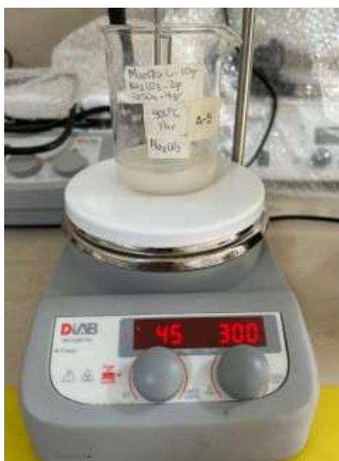
Figura 33. Preparación de carbonato de litio empleando \text{Na}_2\text{CO}_3 y calentando a 45 °C por 60 min a 300RPM.
