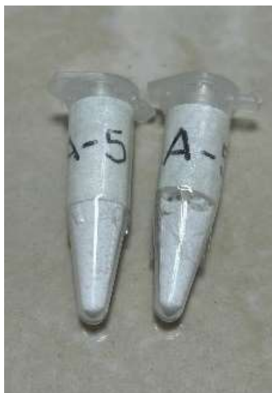
Figura 37. Carbonato de litio en envase para su envío para analizar por SEM y verificar su composición y morfología.
