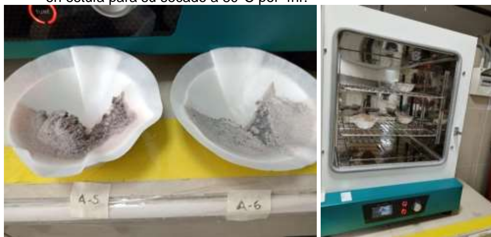
Figura 27. Residuos sólidos húmedos en papeles de filtro y luego fueron colocados en estufa para su secado a 80°C por 4hr.
