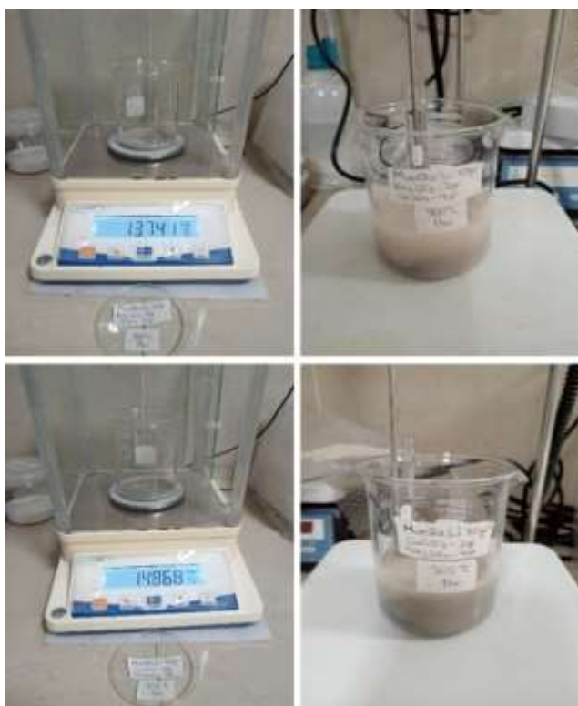
Figura 25. Pesaje de las 2 muestras calcinadas y luego se le adicionó agua destilada en la proporción 1:4
