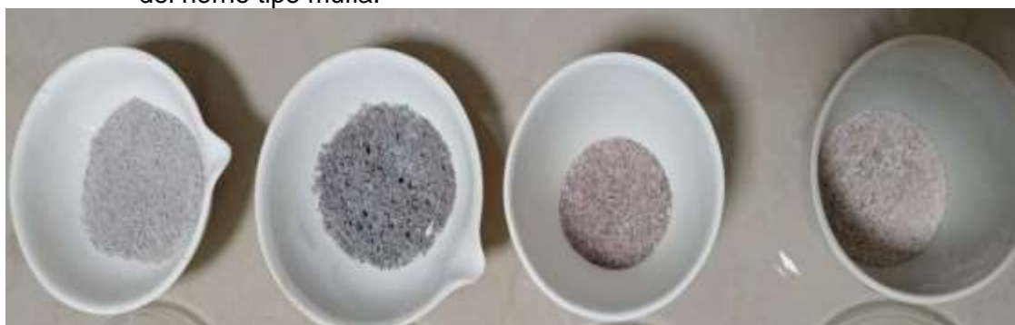
Figura 18. Muestras sometidas a tostación a 900°C por 1hr y luego retiradas del horno tipo mufla.
