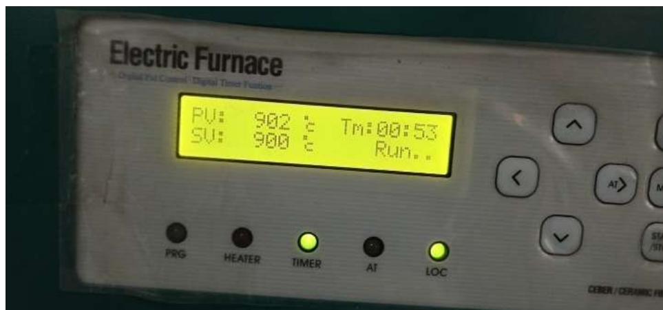
Figura 17. Tostación de las 6 muestras en horno tipo Mufla a 900°C por 1 hr.
