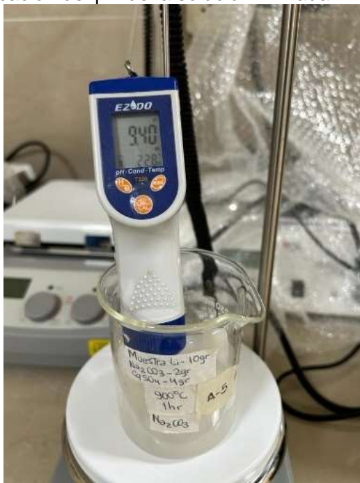
Figura 32. Verificación del pH de la solución lixiviada.
