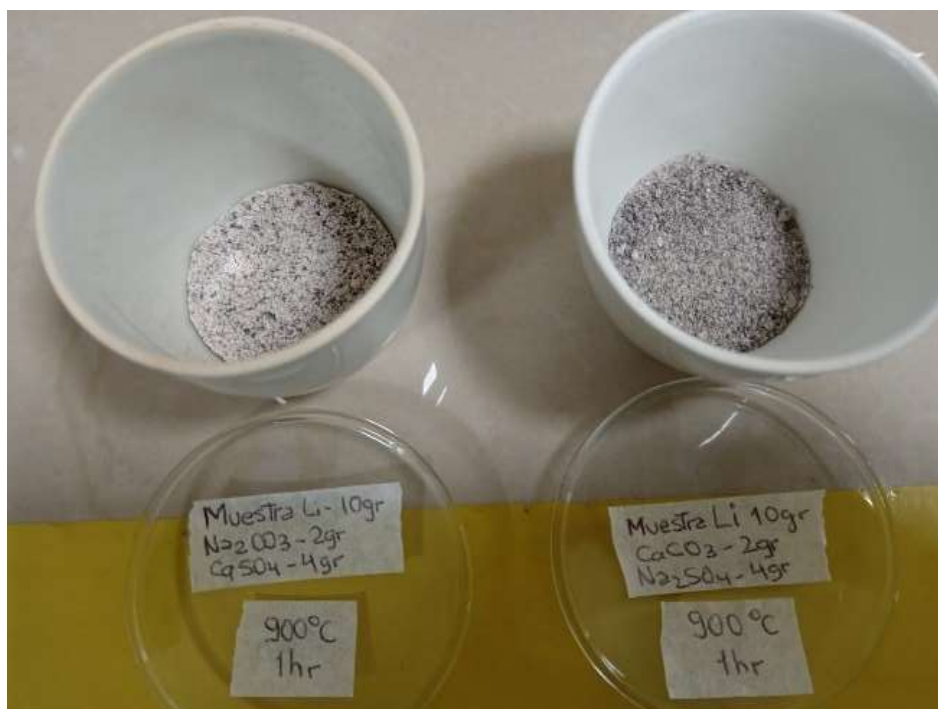
Figura 19. Muestras con contenido de carbonato y sulfato sometidas a tostación a 900°C por 1hr y luego retiradas del horno tipo mufla.
