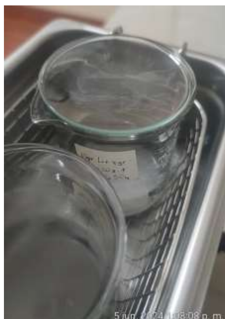
Figura 30. Muestras N°8 y N°9, llevadas con el agua destilada en vasos precipitados al equipo de baño ultrasónico.
