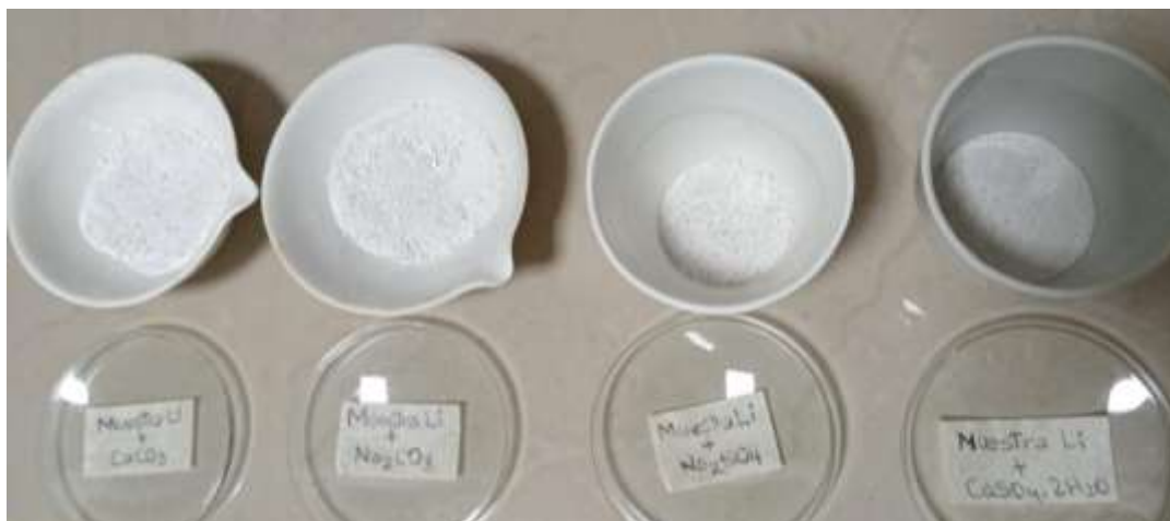
Figura 15. Pesaje de la muestra original de litio en 10gr en 4 crisoles a las cuales se le agregó 2gr de \text{CaCO}_3 , 2gr de \text{Na}_2\text{CO}_3 , 2gr de \text{Na}_2\text{SO}_4 y 2gr de \text{CaSO}_4 \cdot 2\text{H}_2\text{O}
