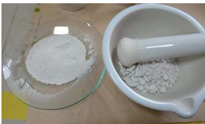
Figura 11. Conversión de la muestra original a “polvo” empleando mortero
