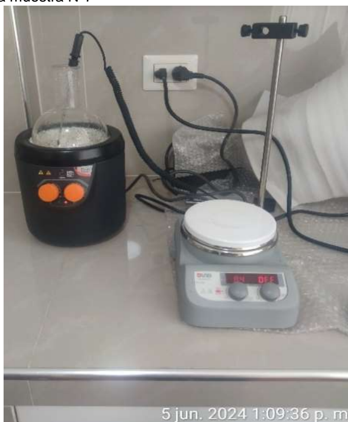
Figura 29. Proceso de lixiviación en Manta Calentadora a 85°C por 60 min de la muestra N°7
