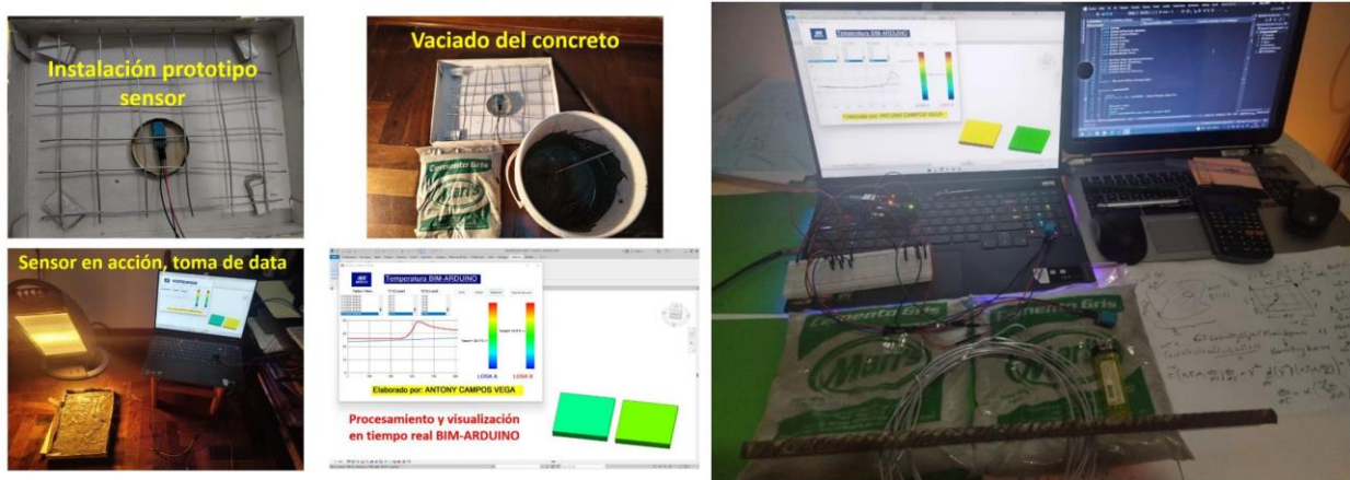
Figura N° 4.138: Sensor introducido en un prototipo de losa de concreto (Fuente: Elaboración propia)
