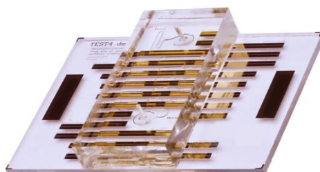
Figura 1.2 Dispositivo de microfluidos de microondas (la barra de escala es de 12 mm). (Fuente: Referencia [54])
