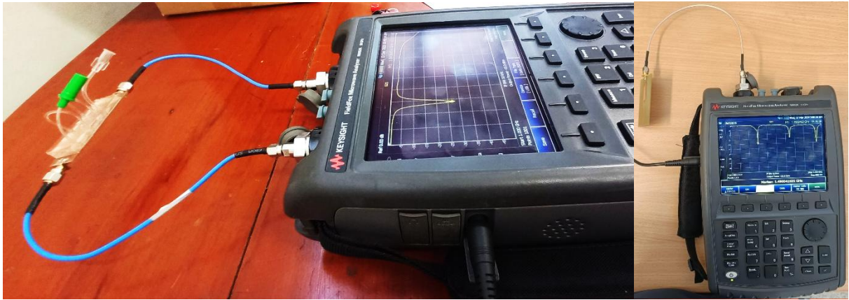
Figura 4.2 Medición y prueba de los CSRR (de 1 y 2 puertos) mediante el analizador de redes vectoriales (VNA) KEYSIGHT N9952A.
