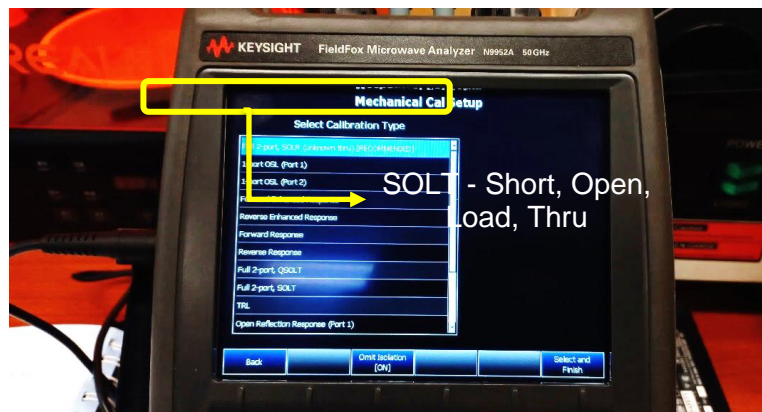
Figura D-3 Preparación del método de calibración, método SOLT.
