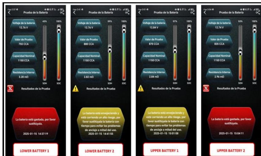
Imagen 28: Resultados de medición de banco baterías Odyssey PC2150
