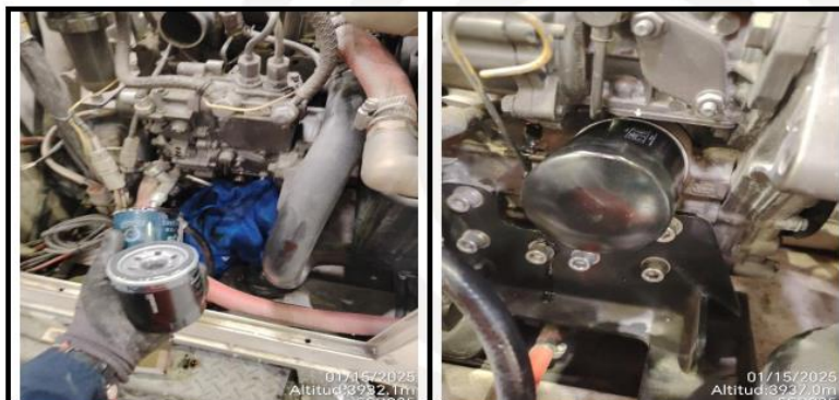
Imagen 12 & 13: Filtro Primario de aceite antes y después
