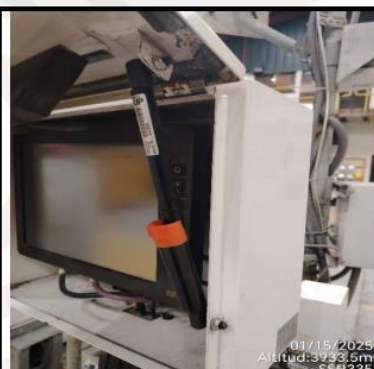
Imagen 26 & 27: Cambio Gas Strut 290 mm – Cubículo contenedor Tablet UI
