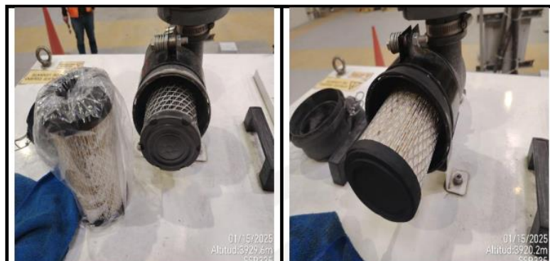
Imagen 16 & 17: Filtro de aire antes y después
