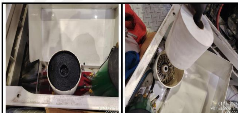
Imagen 14 & 15: Filtro de kit de extensión antes y después
