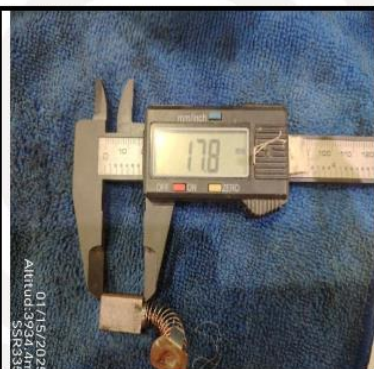
Imagen 24 & 25: Inspección de Carbones.
