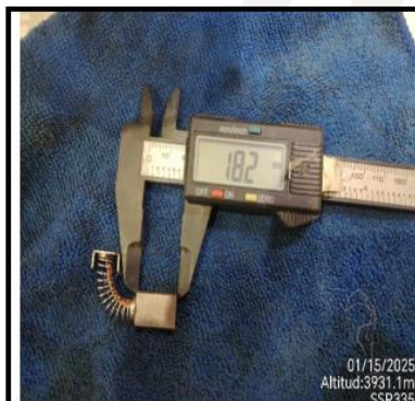
Imagen 24 & 25: Inspección de Carbones.
