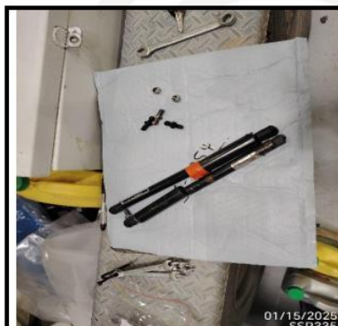
Imagen 26 & 27: Cambio Gas Strut 290 mm – Cubículo contenedor Tablet UI
