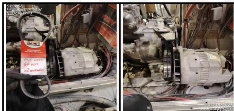
Imagen 18 & 19: Cambio Fajas alternador 24V.
