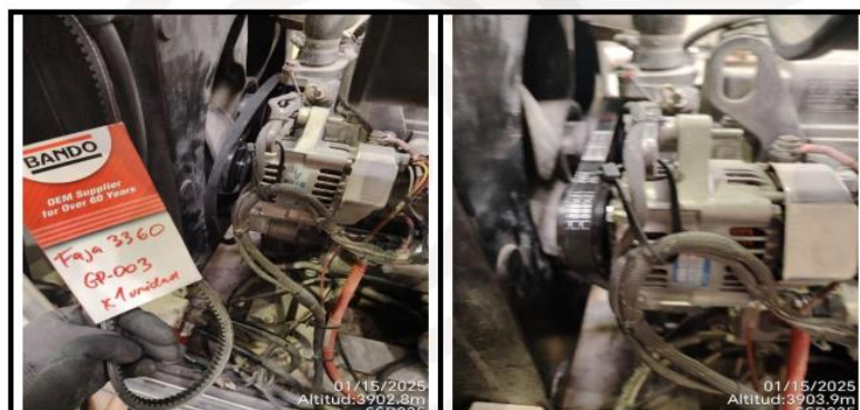
Imagen 20 & 21: Cambio Fajas alternador 12V.
