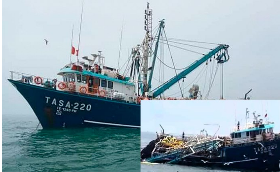
Figura 1- Tasa 220 al inicio y después de la caída del mástil
