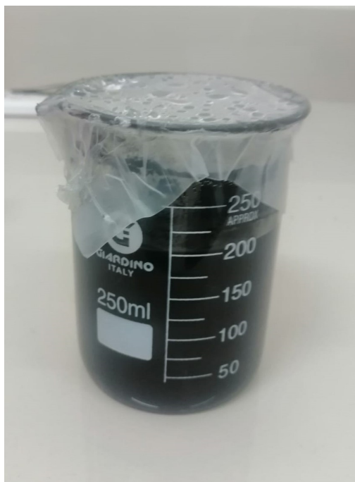
FIGURA XXVII. Suspensión de carbón activado. Para desarrollarlo se usó: 45 g de carbón activado, 9 g de alcohol de polivinilo, 15 g de ácido glutámico y 150 mL de agua destilada.
