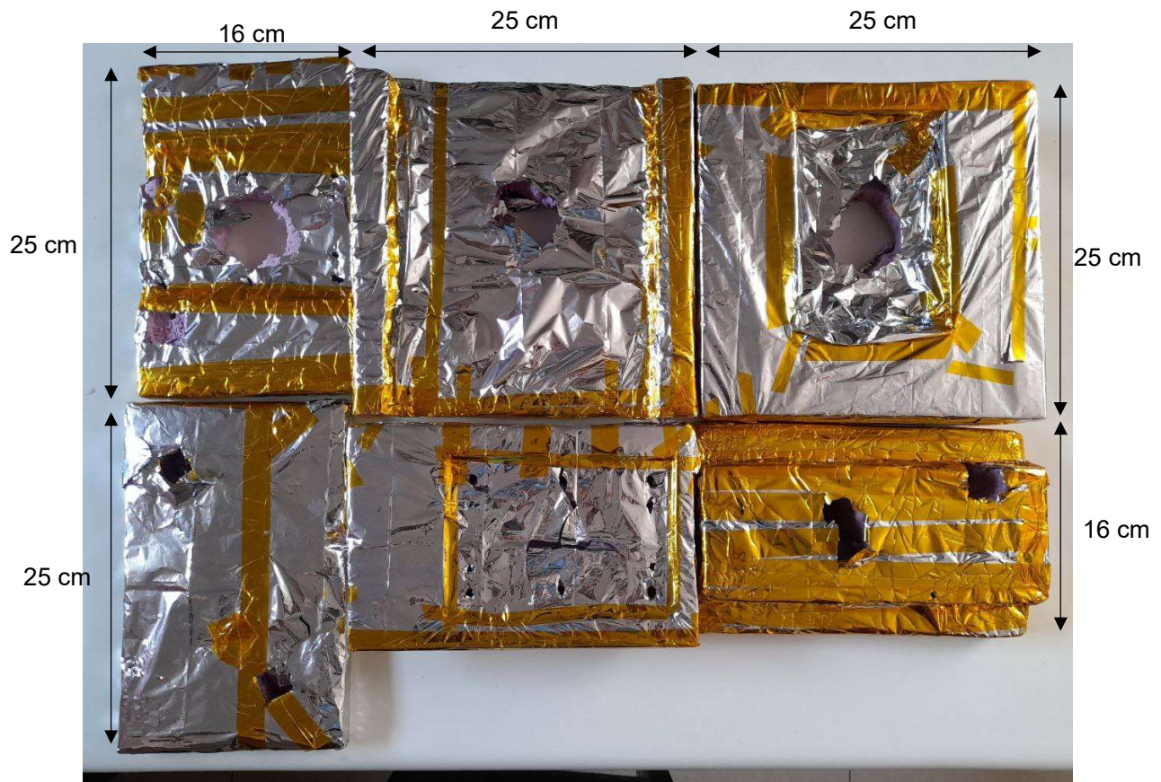
FIGURA XXXVIII. Espuma de poliestireno extruido con mantas térmicas y cinta BGA de alta temperatura.
