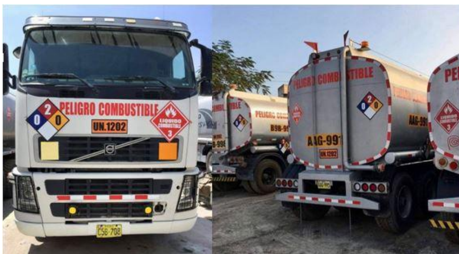
Figura 45 Implementación de señalética en camiones cisterna de hidrocarburos líquidos.
