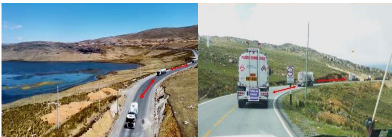
Figura 38 Velocidad a 60km/h y distanciamiento entre cisternas en el transporte de hidrocarburos líquidos.
