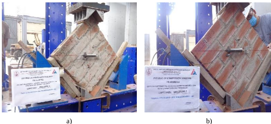
Figura 19. Ensayo de compresión diagonal en muretes de albañilería a) ladrillo sólido artesanal, b) ladrillo tubular
