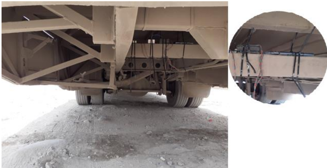
Figura N° 35. Instalación de equipo GPS
