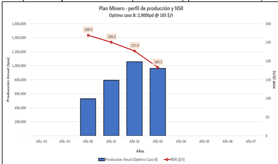
Perfil de producción y NSR – Plan minero para el caso B (óptimo HoV Tradicional)
