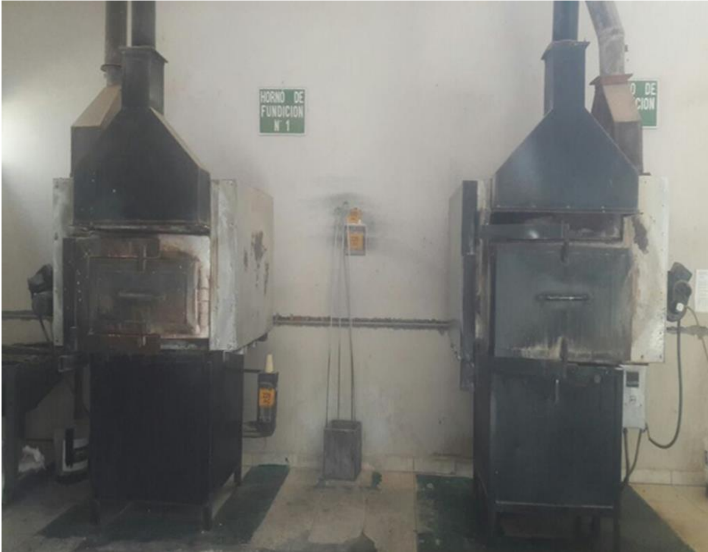
Anexo 7: Zona de fundición por ensayo al fuego para determinar leyes en mineral (cabeza y ripios)
