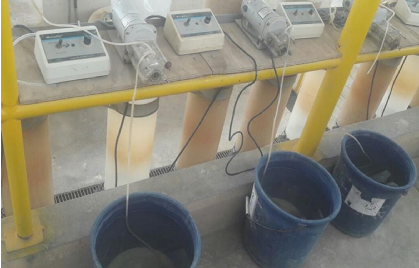
Anexo 3: Bombas peristálticas y baldes para el control de la lixiviación en columnas
