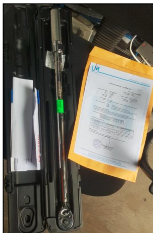
Torquímetro calibrado, identificado y protegido
