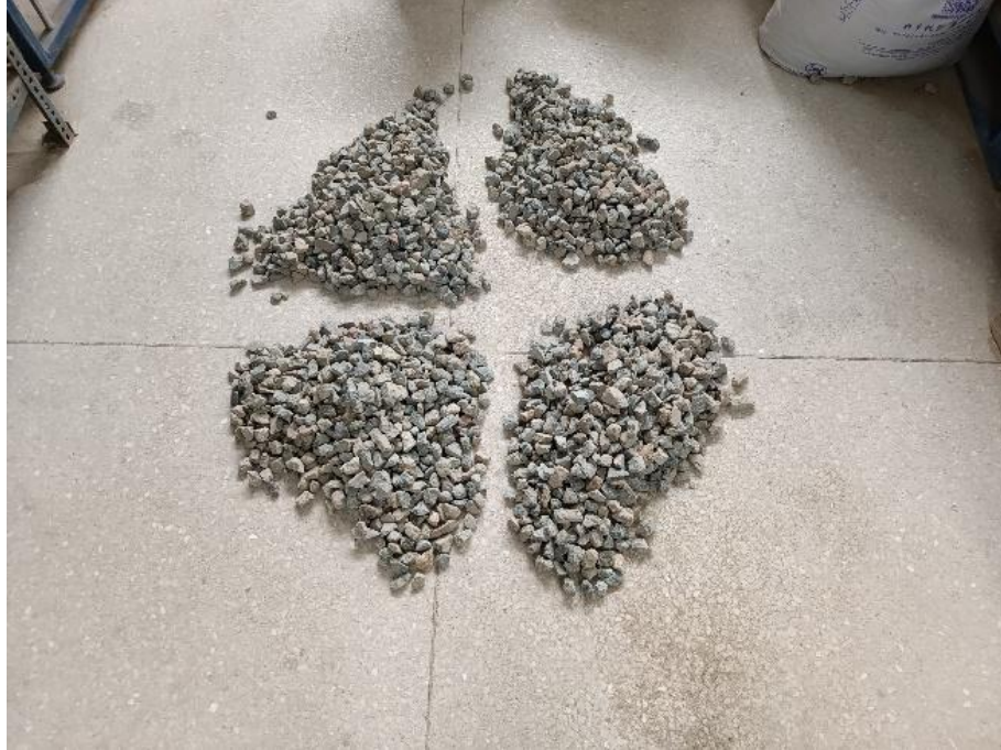
Cuarteo de agregado grueso
