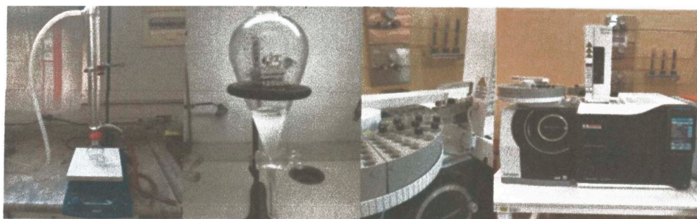
Transesterificación de los FAME del aceite y lectura por cromatografía GC-FID
