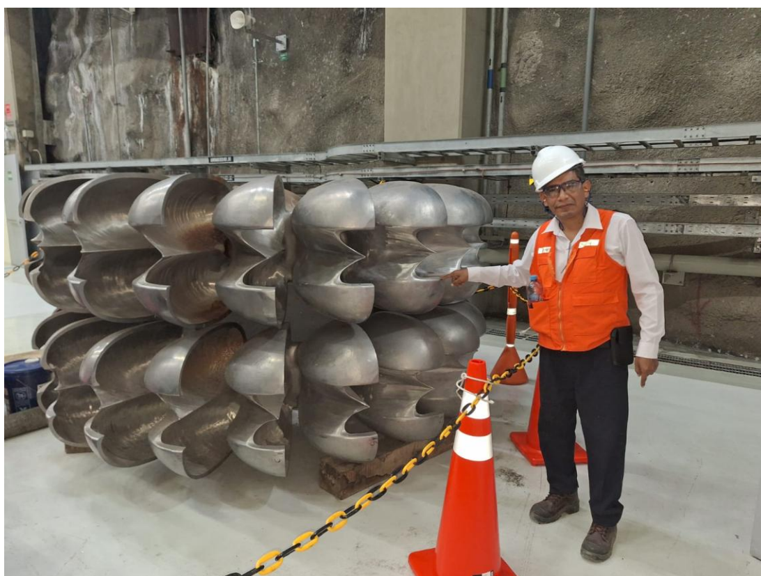
Figura 4.5: Turbina Pelton de la central hidroeléctrica de El Platanal
